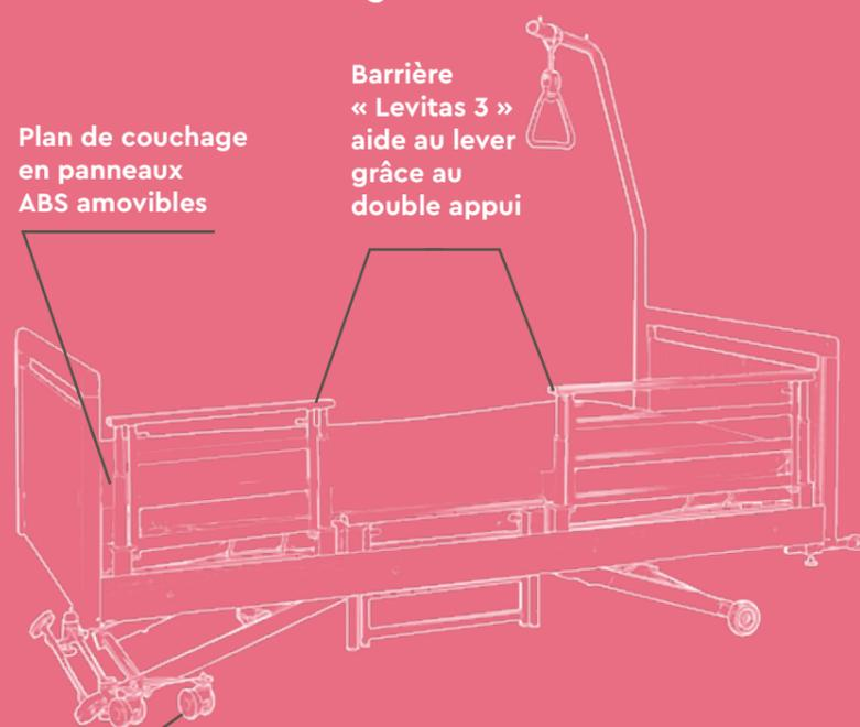
Système de freinage centralisé
